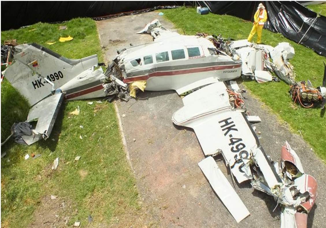
Reconstrucción de los restos de la aeronave HK-4990
