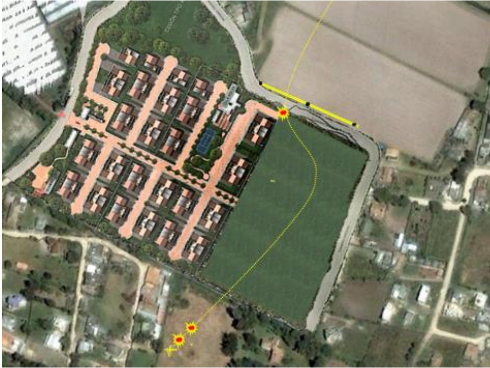
Grafica de la trayectoria y secuencia de los impactos de la aeronave HK4990 en el accidente
