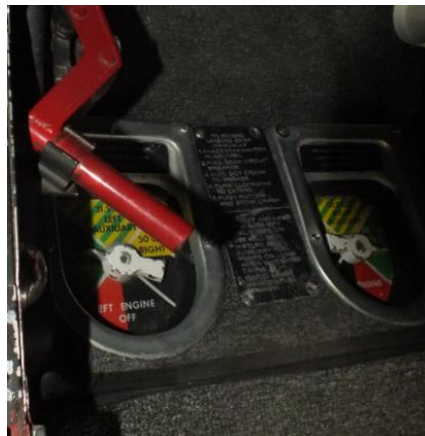
Graficas de las condiciones in situ de las selectoras de combustible de la aeronave HK4990
