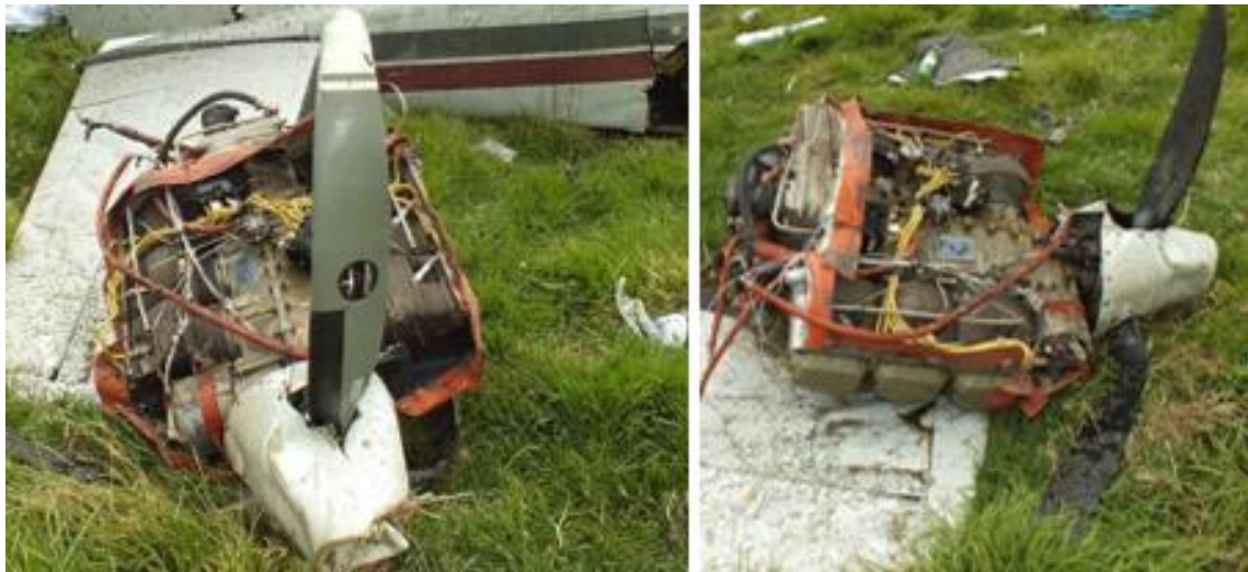
Graficas de las condiciones in situ de la planta motriz derecha de la aeronave HK4990
