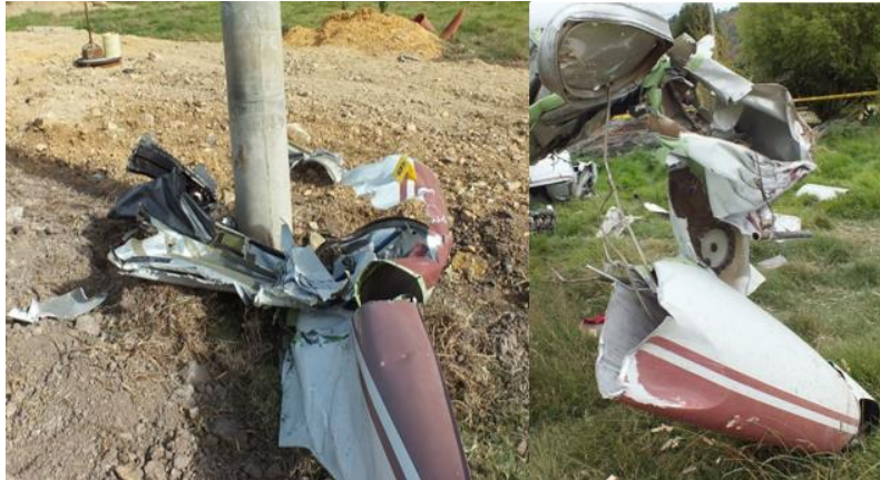
Graficas de las condiciones finales de los tanques de punta de plano de la aeronave HK4990
