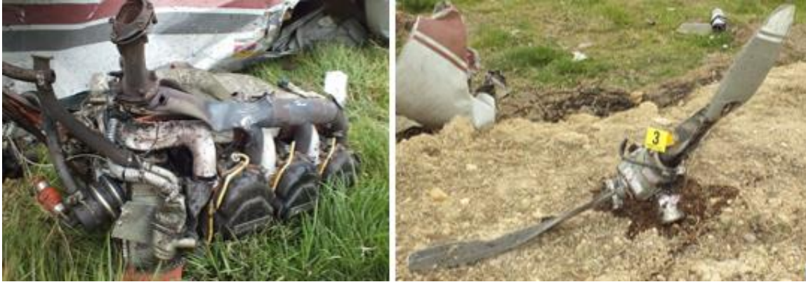
Graficas de las condiciones in situ de la planta motriz y hélice izquierda de la aeronave HK4990
